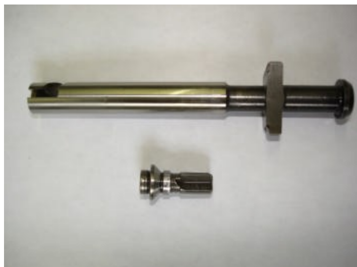
Image 2 : Élément de pompage et clapet de refoulement
